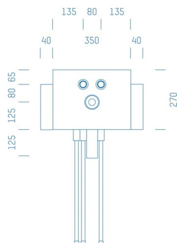
Sanitärmodul f. Waschtisch Zirkulation nur Warmwasser, Boxenstärke: 7cm, Trockenbau, DN20, VALSIR, Rohrführung von unten, Abfluss: JH exklusiv Bogen
