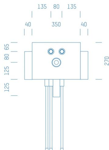
Sanitärmodul f. Waschtisch Zirkulation nur Warmwasser, Boxenstärke: 7cm, Trockenbau, DN20, TECE, Rohrführung von unten, Abfluss: Conel Drain
