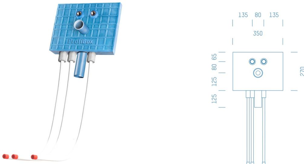
Sanitärmodul f. Waschtisch Zirkulation nur Warmwasser, Boxenstärke: 7cm, Mauerwerk, DN20, KELIT KELEN, Rohrführung von unten, Abfluss: JH exklusiv Bogen
