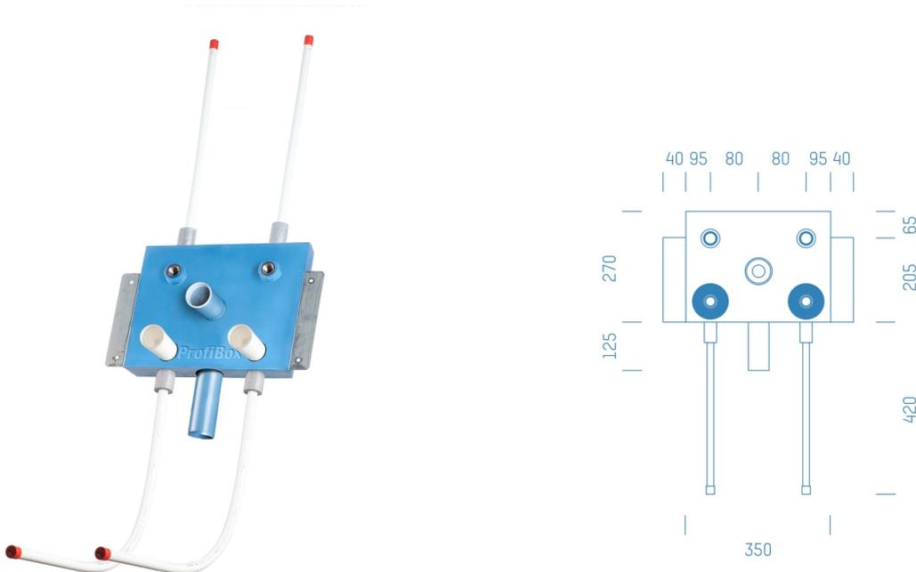
Sanitärmodul f. Waschtisch mit Absperrung Kludi 1/2" KW+WW, Boxenstärke: 7cm, Trockenbau, DN16, Rohrführung von unten, I-FIT, Abfluss: Valsir Tri Plus
