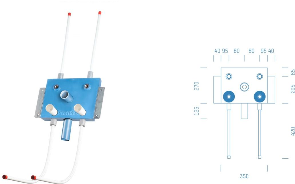
Sanitärmodul f. Waschtisch mit Absperrung Kludi 1/2" KW+WW, Boxenstärke: 7cm, Trockenbau, DN15, Rohrführung von unten, Geberit Mapress Edelstahl, Abfluss: Geberit geschweißt
