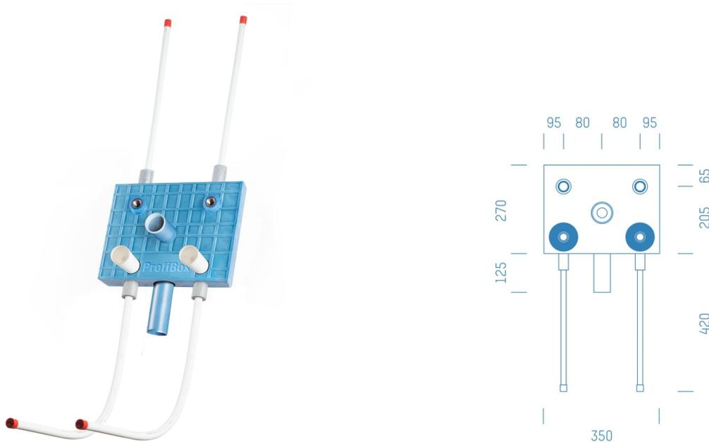
Sanitärmodul f. Waschtisch mit Absperrung Kludi 1/2" KW+WW, Boxenstärke: 7cm, Mauerwerk, DN15, Rohrführung von unten, Rohrführung von unten, KUPFER, Abfluss: Valsir Tri Plus
