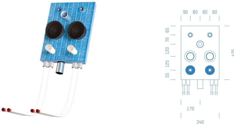
Sanitärmodul f. Waschtisch mit Absperrung Kludi 3/4" KW+WW, Wasserzähler Ista 3/4" KW+WW, Boxenstärke: 7cm, Mauerwerk, DN15, Rohrführung von unten, KUPFER, Abfluss: Geberit geschweißt
