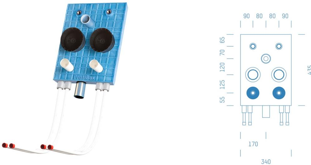
Sanitärmodul f. Waschtisch mit Absperrung Kludi 3/4" KW+WW, Wasserzähler Ista 3/4" KW+WW, Boxenstärke: 7cm, Mauerwerk, DN15, Rohrführung von unten, KUPFER, Abfluss: Conel Drain
