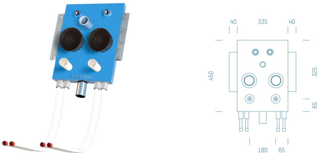
Sanitärmodul f. Waschtisch mit Absperrung Grohe 3/4" KW+WW, Wasserzähler Techem 3/4" KW+WW,
