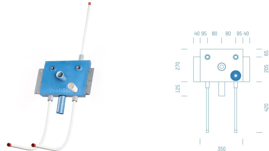
Sanitärmodul f. Waschtisch mit Absperrung Kaltwasser Grohe 1/2", Boxenstärke: 7cm, Trockenbau, DN16, Rohrführung von unten, FRÄNKISCH ALPEX, Abfluss: Master 3
