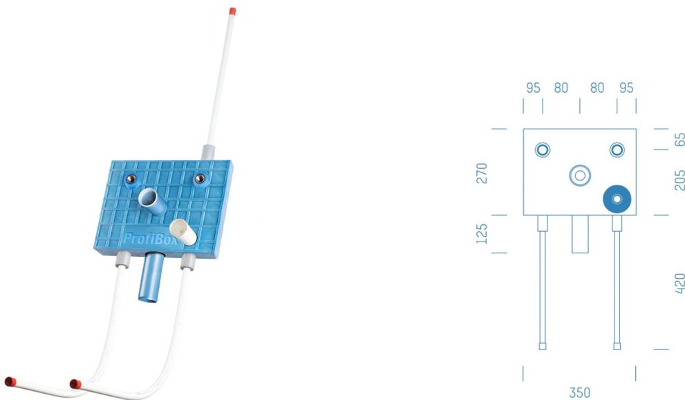
Sanitärmodul f. Waschtisch mit Absperrung Kaltwasser Grohe 1/2", Boxenstärke: 7cm, Mauerwerk, DN20, Rohrführung von unten, I-FIT, Abfluss: Geberit geschweißt
