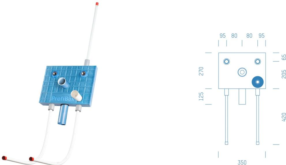
Sanitärmodul f. Waschtisch mit Absperrung Kaltwasser Grohe 1/2", Boxenstärke: 7cm, Mauerwerk, DN20, Rohrführung von unten, Alva Acta PE System, Abfluss: Geberit geschweißt
