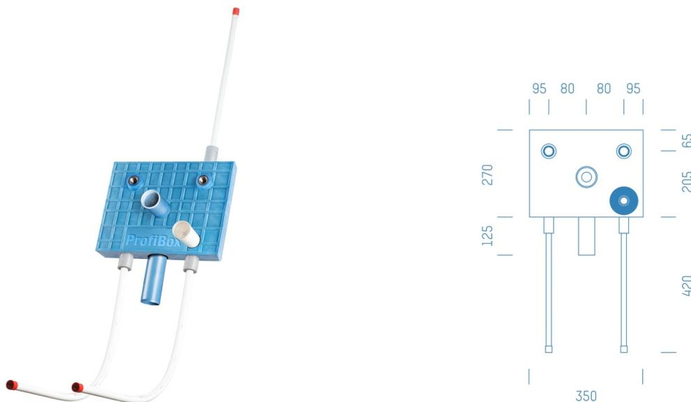
Sanitärmodul f. Waschtisch mit Absperrung Kaltwasser Grohe 1/2", Boxenstärke: 7cm, Mauerwerk, DN16, Rohrführung von unten, ALU-VB-ROHR frei wählbar, Abfluss: frei wählbar
