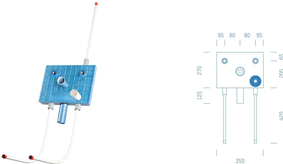
Sanitärmodul f. Waschtisch mit Absperrung Kaltwasser Grohe 1/2", Boxenstärke: 7cm, Mauerwerk, DN16, Rohrführung von unten, TECE, Abfluss: Rehau Raupiano
