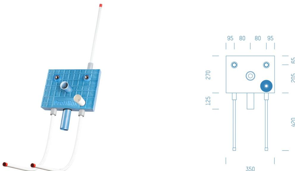
Sanitärmodul f. Waschtisch mit Absperrung Kaltwasser Grohe 1/2", Boxenstärke: 7cm, Mauerwerk, DN16, Rohrführung von unten, KELOX, Abfluss: JH exklusiv Bogen
