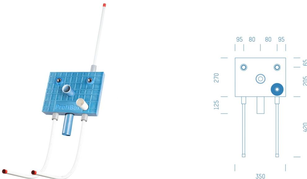
Sanitärmodul f. Waschtisch mit Absperrung Kaltwasser Grohe 1/2", Boxenstärke: 7cm, Mauerwerk, DN16, Rohrführung von unten, I-FIT, Abfluss: Geberit geschweißt
