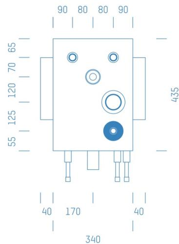
Sanitärmodul f. Waschtisch mit Absperrung Kludi 3/4" KW, Wasserzähler Techem 3/4" KW, Boxenstärke: 7cm, Trockenbau, DN20, Rohrführung von unten, VIEGA SANFIX FOSTA, Abfluss: Master 3
