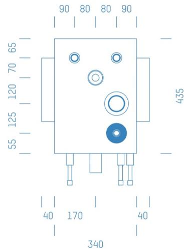
Sanitärmodul f. Waschtisch mit Absperrung Kludi 3/4" KW, Wasserzähler Techem 3/4" KW, Boxenstärke: 7cm, Trockenbau, DN20, Rohrführung von unten, SANIPEX MT, Abfluss: Rehau Raupiano
