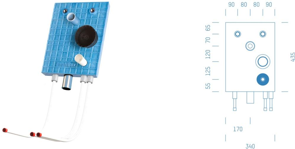
Sanitärmodul f. Waschtisch mit Absperrung Kludi 1/2" KW, Wasserzähler Ista 1/2" KW, Boxenstärke: 7cm, Mauerwerk, DN16, Rohrführung von unten, WINKLER, Abfluss: Valsir Tri Plus
