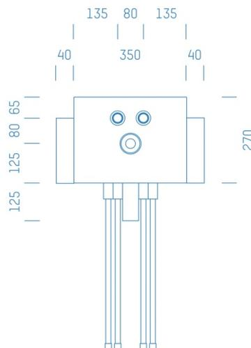
Sanitärmodul f. Waschtisch Zirkulation, Boxenstärke: 7cm, Trockenbau, DN20, I-FIT, Rohrführung von unten, Abfluss: Polokal NG
