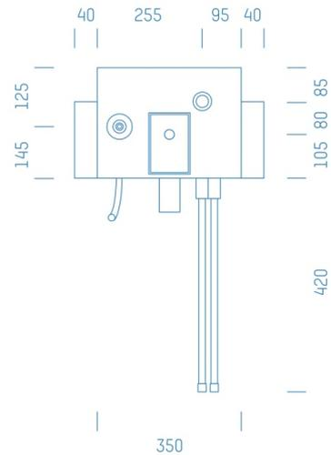
Sanitärmodul f. Waschmaschine Zirkulation mit HL405, Boxenstärke: 7cm, Trockenbau, DN16, FRÄNKISCH ALPEX, Rohrführung von oben
