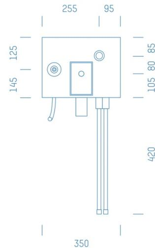
Sanitärmodul f. Waschmaschine Zirkulation mit HL400, Boxenstärke: 7cm, Mauerwerk, DN20, PRINETO, Rohrführung von unten
