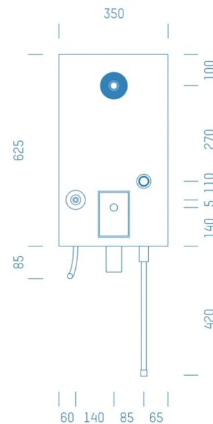
Sanitärmodul f. Waschmaschine mit Absperrung Kludi 1/2", Boxenstärke: 7cm, Mauerwerk, DN18, Geberit Mapress Edelstahl, Rohrführung von unten
