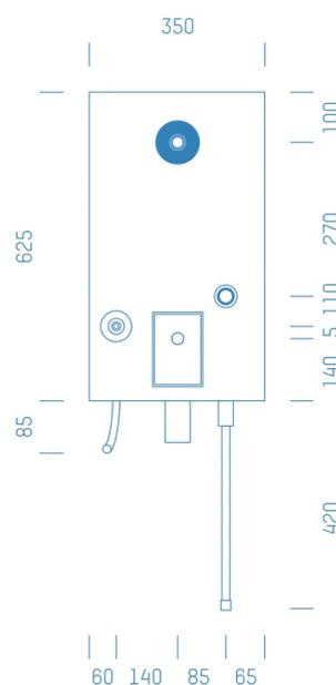
Sanitärmodul f. Waschmaschine mit Absperrung Kludi 1/2", Boxenstärke: 7cm, Mauerwerk, DN16, ALU-VB-ROHR frei wählbar, Rohrführung von unten
