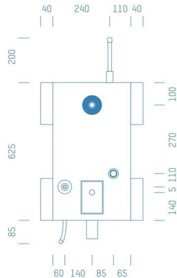
Sanitärmodul f. Waschmaschine mit Absperrung Grohe 3/4", Boxenstärke: 7cm, Trockenbau, DN20, Alva Acta Aluverbundrohr, Rohrführung von oben
