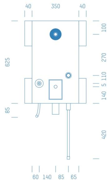
Sanitärmodul f. Waschmaschine mit Absperrung Grohe 3/4", Boxenstärke: 7cm, Trockenbau, DN16, VALSIR, Rohrführung von unten
