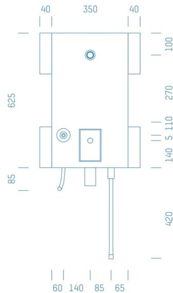
Sanitärmodul f. Waschmaschine mit HL405 Kaltwasserleitung oben , Boxenstärke: 7cm, Trockenbau, DN15, KUPFER, Rohrführung von unten
