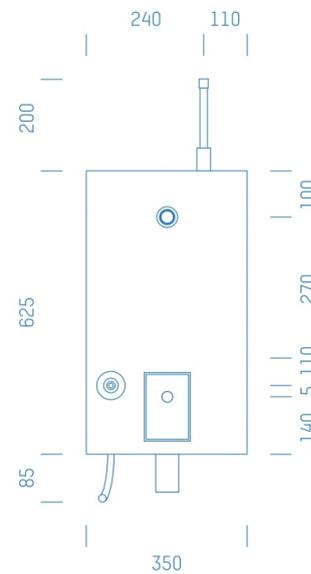
Sanitärmodul f. Waschmaschine mit HL405 Kaltwasserleitung oben , Boxenstärke: 7cm, Mauerwerk, DN20, IVT Pripres, Rohrführung von oben
