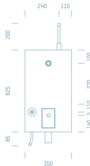
Sanitärmodul f. Waschmaschine mit HL405 Kaltwasserleitung oben , Boxenstärke: 7cm, Mauerwerk, DN16, TECE, Rohrführung von oben
