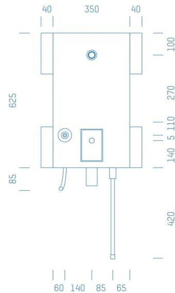
Sanitärmodul f. Waschmaschine mit HL400 Kaltwasserleitung oben , Boxenstärke: 7cm, Trockenbau, DN20, VIEGA RAXOFIX, Rohrführung von unten
