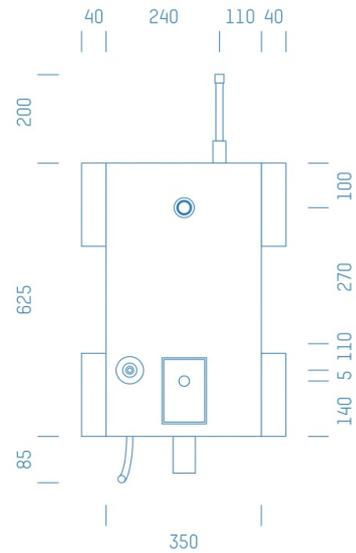
Sanitärmodul f. Waschmaschine mit HL400 Kaltwasserleitung oben , Boxenstärke: 7cm, Trockenbau, DN20, IVT Pripres, Rohrführung von oben
