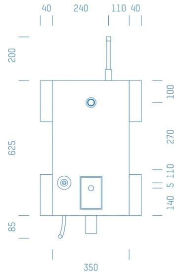
Sanitärmodul f. Waschmaschine mit HL400 Kaltwasserleitung oben , Boxenstärke: 7cm, Trockenbau, DN20, CONNECT, Rohrführung von oben
