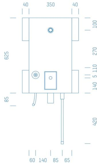
Sanitärmodul f. Waschmaschine mit HL400 Kaltwasserleitung oben , Boxenstärke: 7cm, Trockenbau, DN20, Alva Acta PE System, Rohrführung von unten
