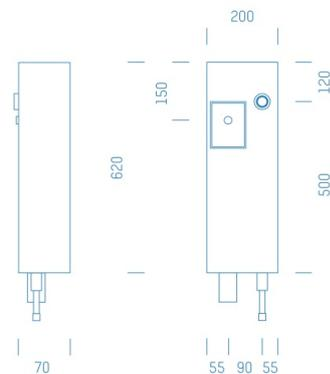
Sanitärmodul f. Waschmaschine lang mit HL400, Boxenstärke: 7cm, Mauerwerk, Rohrführung von unten, DN20, PRINETO
