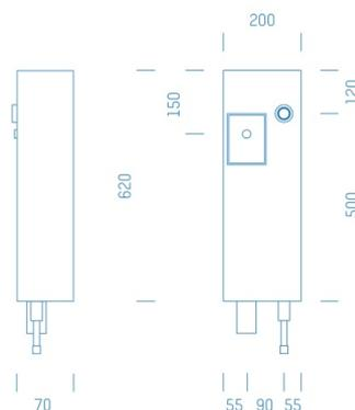
Sanitärmodul f. Waschmaschine lang mit HL400, Boxenstärke: 7cm, Mauerwerk, Rohrführung von unten, DN16, ALU-VB-ROHR frei wählbar
