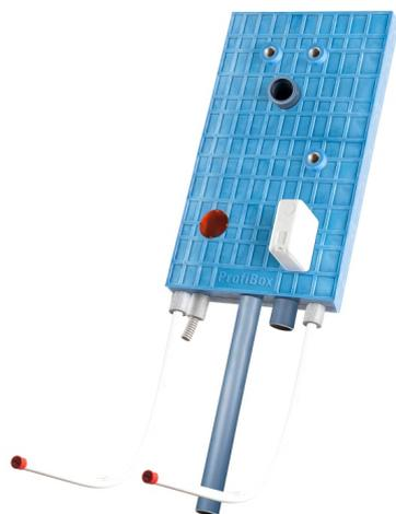
Sanitärmodul f. Waschmaschine mit Elektrospeicher, Boxenstärke: 7cm, Rohrführung von unten, Mauerwerk, DN20, FLOWFIT, Abfluss: Master 3
