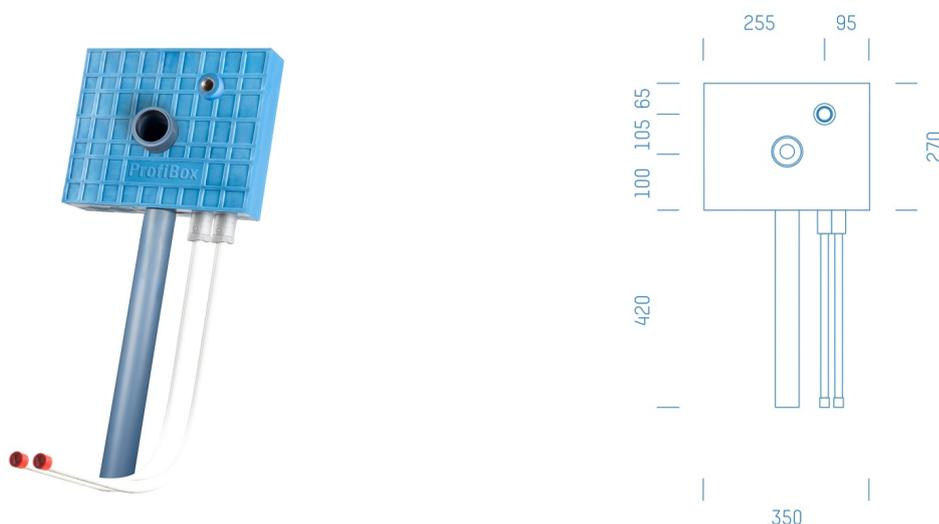
Sanitärmodul f. Spültisch drucklos Zirkulation, Boxenstärke: 7cm, Mauerwerk, DN18, KUPFER, Rohrführung von oben, Abfluss: Master 3
