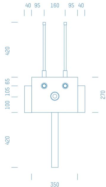
Sanitärmodul f. Spültisch, Boxenstärke: 7cm, Trockenbau, DN16, MAINPEX, Rohrführung von oben, Abfluss: Valsir Tri Plus
