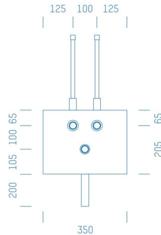
Sanitärmodul f. Elektrospeicher, Boxenstärke: 7cm, Mauerwerk, DN15, Geberit Mapress Edelstahl, Rohrführung von oben, Abfluss: Polokal NG
