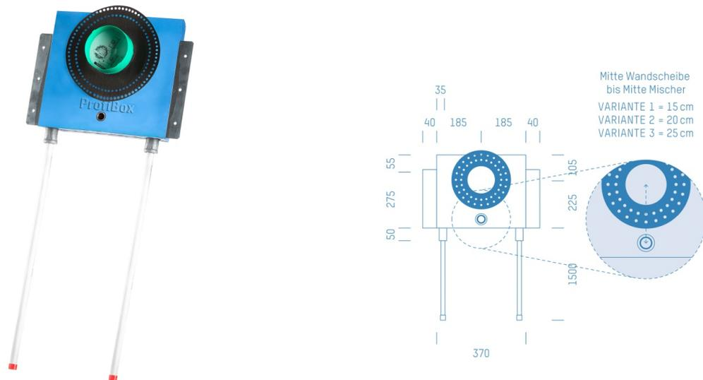
Sanitärmodul f. Dusche-Unterputzmischer Hansabluebox 8001 ( mit Vorabsperung), Handbrausen-Anschluss unten 25cm, Boxenstärke: 7cm, Trockenbau, DN20, Alva Acta Aluverbundrohr
