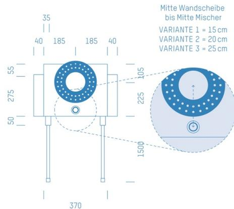
Sanitärmodul f. Dusche-Unterputzmischer Hansabluebox 8001 ( mit Vorabsperung), Handbrausen-Anschluss unten 25cm, Boxenstärke: 7cm, Trockenbau, DN16, MAINPEX
