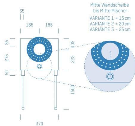
Sanitärmodul f. Dusche-Unterputzmischer Hansabluebox 8001 ( mit Vorabsperung), Handbrausen-Anschluss unten 20cm, Boxenstärke: 7cm, Mauerwerk, DN16, CONNECT
