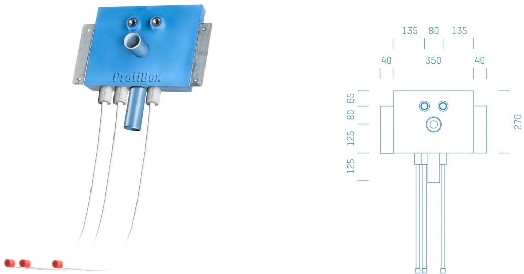
Sanitärmodul f. Waschtisch Zirkulation nur Warmwasser, Boxenstärke: 7cm, Trockenbau, DN16, KELOX, Rohrführung von unten, Abfluss: Valsir Tri Plus
