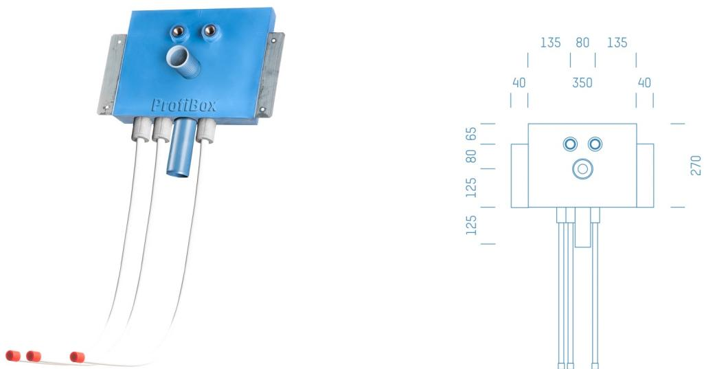
Sanitärmodul f. Waschtisch Zirkulation nur Warmwasser, Boxenstärke: 7cm, Trockenbau, DN16, KELOX, Rohrführung von unten, Abfluss: Rehau Raupiano
