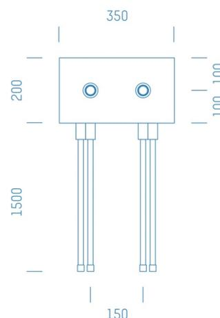
Sanitärmodul f. Badewannen Zirkulation Kalt-und Warmwasser, Boxenstärke: 5cm, Mauerwerk, DN16, WAVIN
