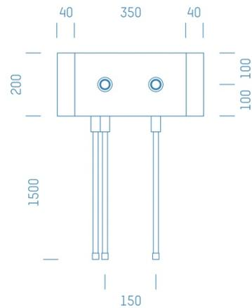
Sanitärmodul f. Badewannen Zirkulation mit Spritzwasserhülsen nur Warmwasser, Boxenstärke: 5cm, Trockenbau, DN20, SANIPEX MT
