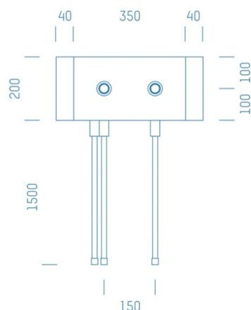
Sanitärmodul f. Badewannen Zirkulation mit Spritzwasserhülsen nur Warmwasser, Boxenstärke: 5cm, Trockenbau, DN16, MAINPEX
