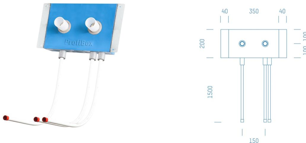
Sanitärmodul f. Badewannen Zirkulation mit Spritzwasserhülsen nur Kaltwasser, Boxenstärke: 5cm, Trockenbau, DN20, CONNECT
