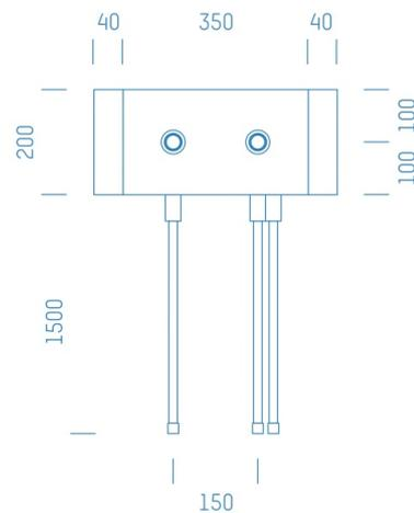
Sanitärmodul f. Badewannen Zirkulation mit Spritzwasserhülsen nur Kaltwasser, Boxenstärke: 5cm, Trockenbau, DN20, Alva Acta PE System
