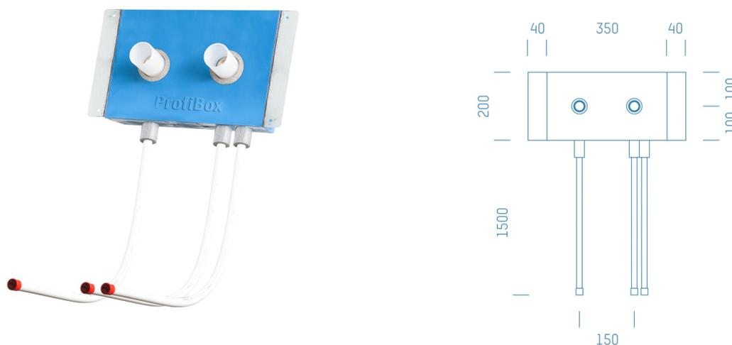
Sanitärmodul f. Badewannen Zirkulation mit Spritzwasserhülsen nur Kaltwasser, Boxenstärke: 5cm, Trockenbau, DN16, REHAU
